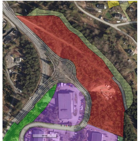
Figur 35 - Reguleringsplan med skoletomt (rødt område) og planlagt omlegging av FV11 veisammenstilt med ortofoto med eksisterende veisituasjon. Kilde: Askerkart 26.04.22.
